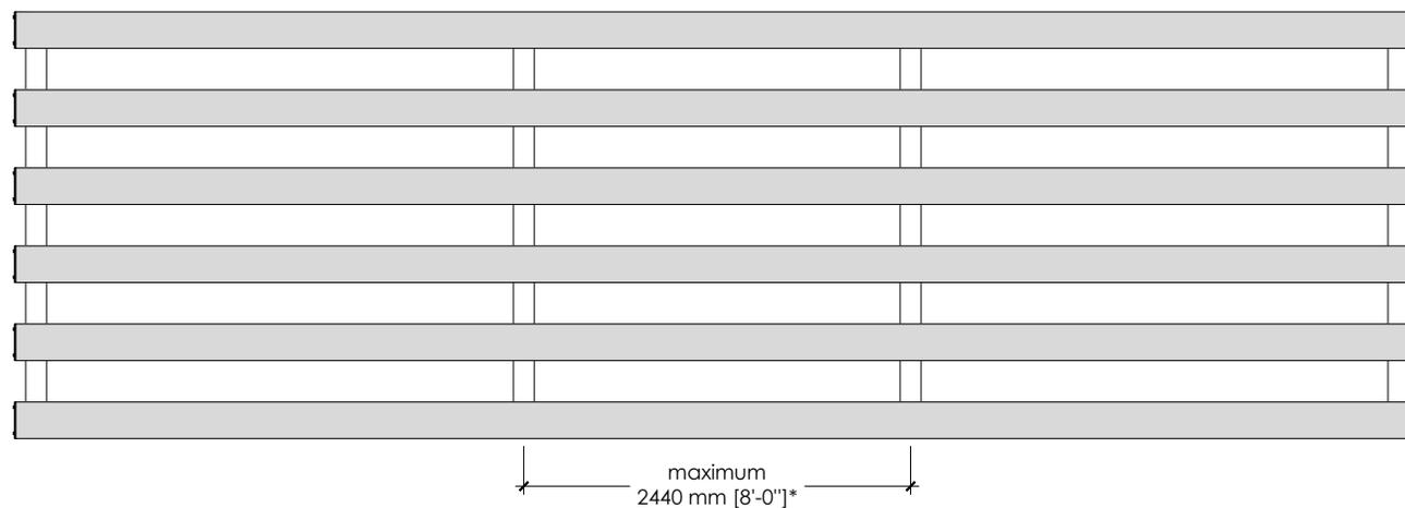
\* Portée maximale de la lame 20 x 89 lorsqu'installée à la verticale (debout)
