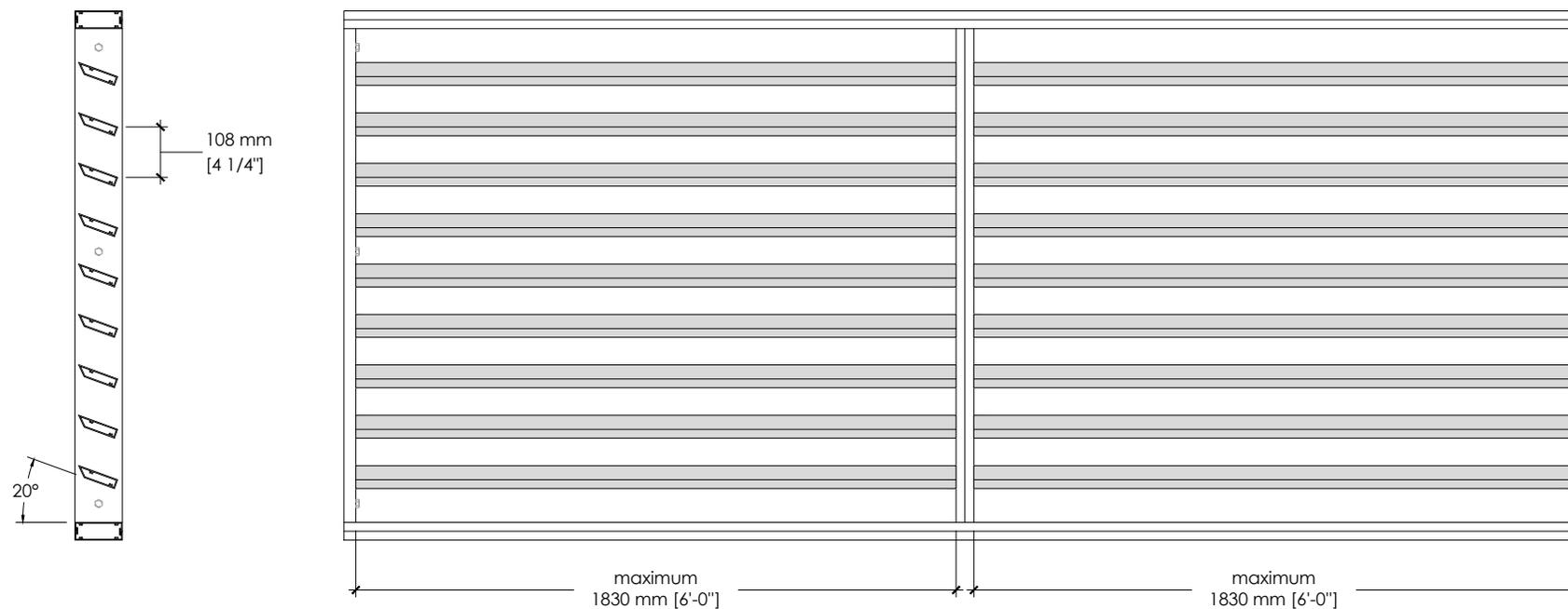
\* Portée maximale de la lame 20 x 89-45 lorsqu'installée à moins de 45°
