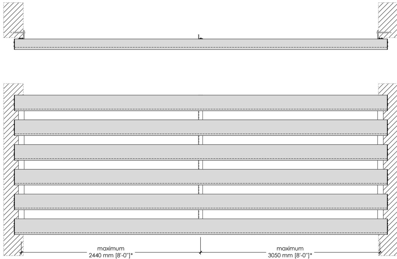
\* Portée maximale de la lame 25 x 155-37 lorsqu'installée à 37°
