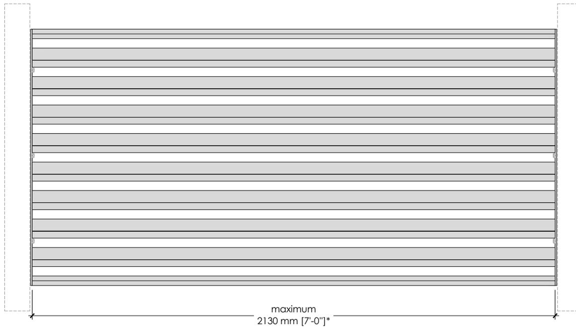
\* Portée maximale de la lame 20 x 89-45 lorsqu'installée à 45°
