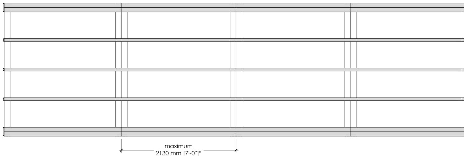
\* Portée maximale de la lame 25 x 140 lorsqu'installée à l'horizontale (couché)
