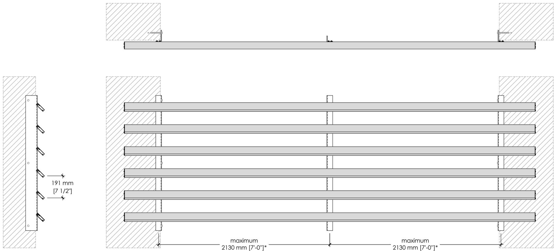
\* Portée maximale de la lame 20 x 89-45 lorsqu'installée à 45°
